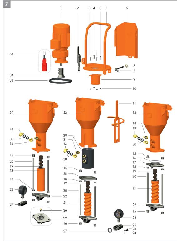
**7 Gummimischrohr und Mischrohr**
