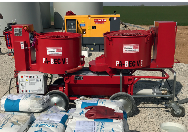
Förderpumpensystem PA-BEC V easy im Einsatz für den Unterguss an Windenergieanlagen verschiedenster Bauformen
