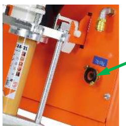
Abb. 120: Schmutzfängersieb im Wassereinlauf
