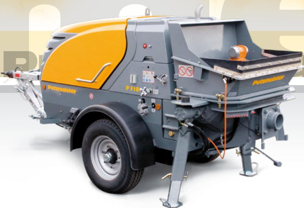
Die neue Doppelkolbenpumpe P 718 ist unsere derzeit leistungsstärkste Feinbetonpumpe. Vorbild sind die großen „Putzmeister-Betonpumpen“, die bereits beim Bau des Burj Dubai Beton bis in über 600 m Höhe gefördert haben. Die neue P 718 bietet jetzt diese Weltrekordtechnik auf deutlich kleinerem Raum. 70 bar Förderdruck, eine Fördermenge von bis zu 18 m<sup>3</sup>/h und eine max. Korngröße von 32 mm sprechen für sich.
