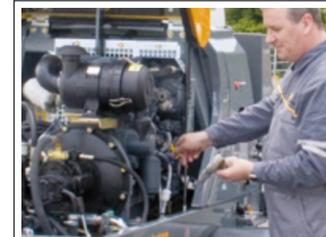
Ist die Haube einmal offen, fällt der **aufgeräumte und gut zugängliche Motorraum** auf. Sie erreichen dadurch schnell und bequem alle Bereiche für Wartung und Service.
