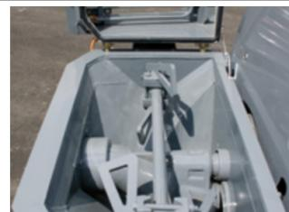
Auf dem wegklappbaren Sicherheitsgitter des Trichters ist ein **Rüttler** aufmontiert. Er sorgt für kontinuierlichen Materialfluss. Der **große Trichter fasst 360 l** und ist so konstruiert, dass er zu fast 100% leergepumpt werden kann.
