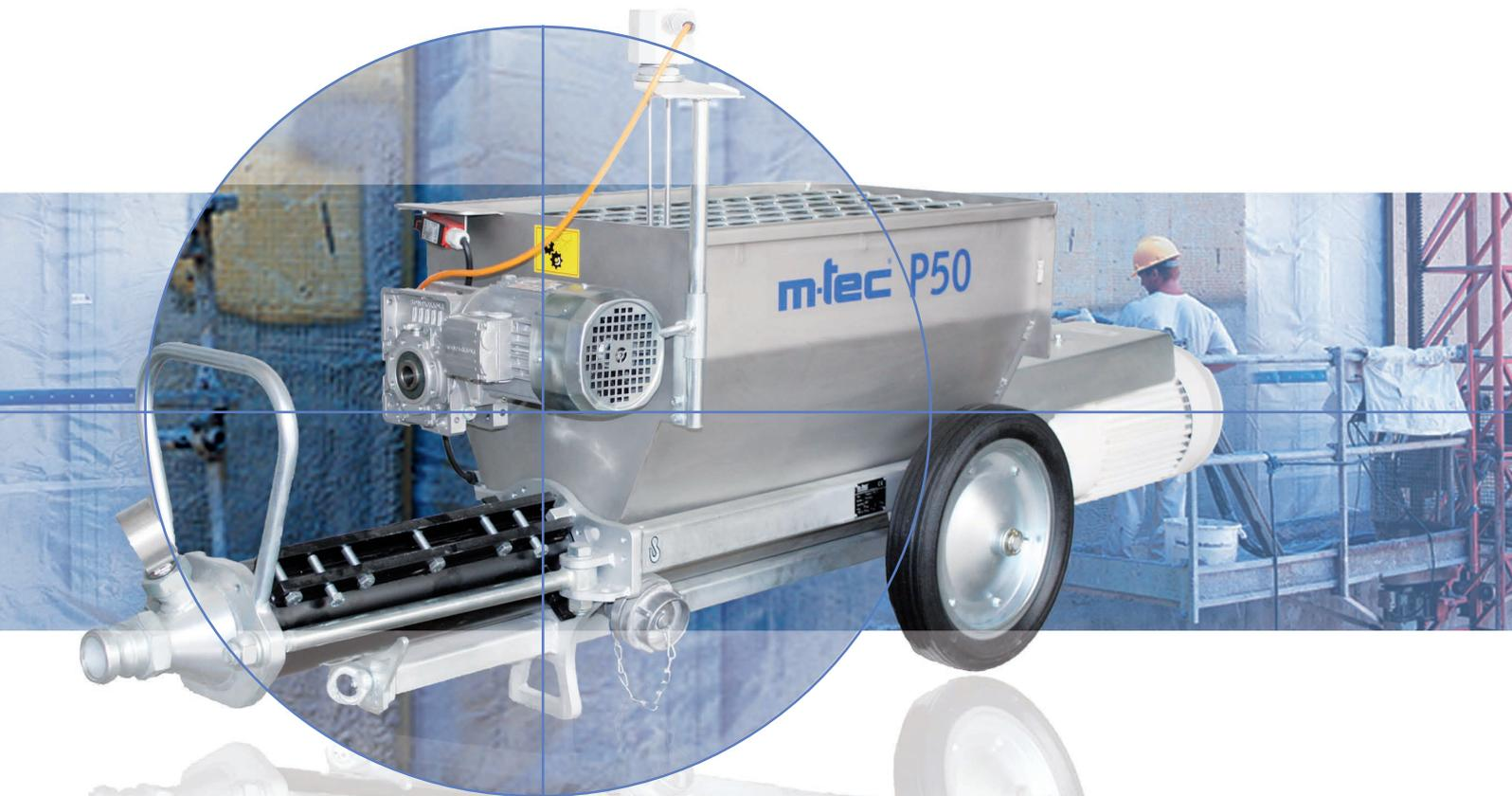
Die m-tec P50 ist eine kraftvolle Pumpe zum Verarbeiten von pumpfähigen Produkten bis 8 mm Körnung. Dabei wird die P50 hauptsächlich bei der Verarbeitung von Mörtel, Beton, Putz oder Edelputz sowie Fließestrich eingesetzt. Für die unterschiedlichen Einsatzgebiete stehen verschiedene Optionen mit Fördermengen bis zu 110 l/min zur Auswahl.
