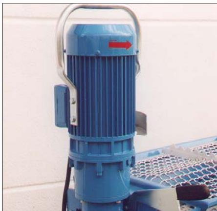
Leichter und kleiner 5,5 kW Pumpenmotor mit Schutzbügel.
