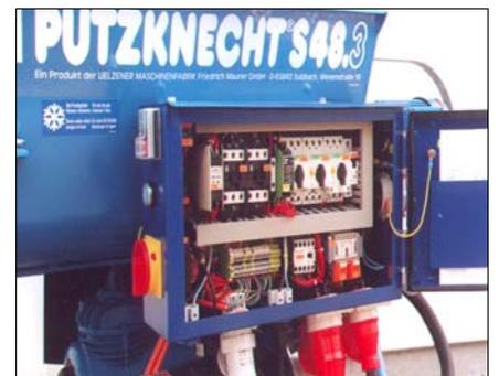
Verbesserte Elektrische Steuerung mit Drehrichtungsautomatik und Wiedereinschaltsperre
