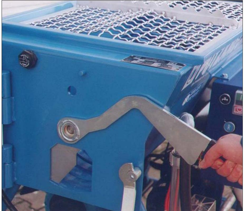
Verbesserter Schieber zwischen Trockenbehälter und Mischkammer. Voll geladnen mit trocken Material kann die Arbeit unterbrochen werden.
