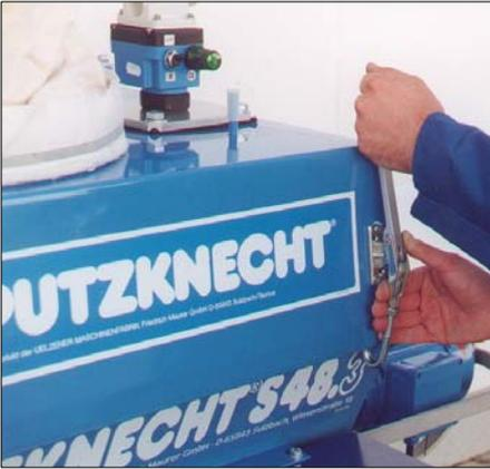
Einfache Montage der Einblashaube durch Hakenverschlüsse und längsseitige Profilkanten
