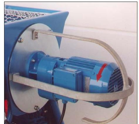
Förderschneckenmotor lässt sich zur Transporterleichterung und der bequemen Reinigung nach Lösen von 3 Ringmuttern abnehmen.
