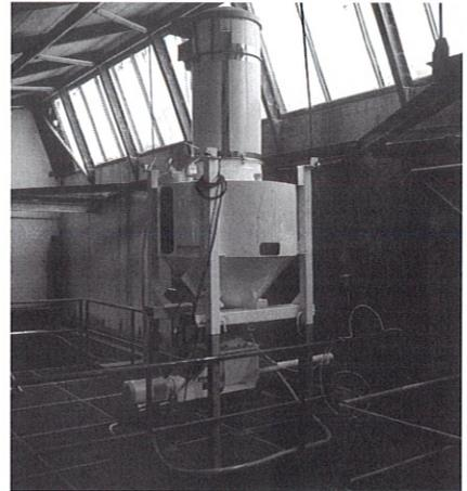
Kleincontainer mit Dosierer und Aufsatzfilter
