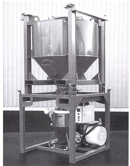
Option: Maschinenträgermodul für Förderanlage, Putzmaschine und Durchlaufmischer
